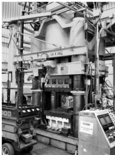
Fig. 6.4 200 ton press forge [360] (courtesy of H.C. Starck).
